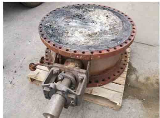
某石化厂采用三偏心蝶阀使用情况
